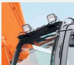
Дополнительные передние фонари освещения на крыше кабины
