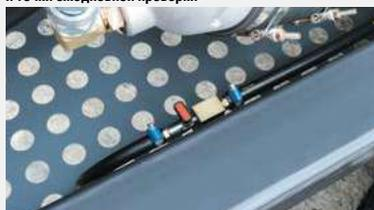
Кран слива отстоя из топливного бака
